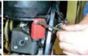
Déposez les deux vis de fixation de la bobine haute tension avec une clé à pipe de 8 et la retirer.
