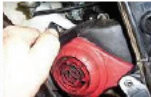
Pour les modèles à refroidissement air, retirez les vis de fixation du cache allumage avec un tournevis cruciforme et le déposer.
