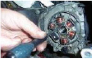
Retirez les vis de fixation du stator avec un tournevis cruciforme.
