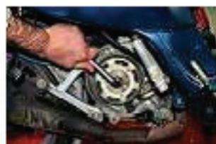
Tournez le rotor dans le sens inverse du sens de rotation pour que le piston vienne en contact avec le bloc piston. Déserrez l'écrou du rotor avec une clé à pipe de 15.
