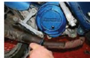
Pour les modèles à refroidissement liquide, retirez les vis du cache allumage avec un tournevis cruciforme.
