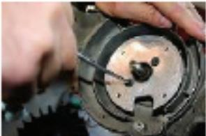
Montage de la platine à l'aide de deux vis 5x16 têtes fraisées fournies.
