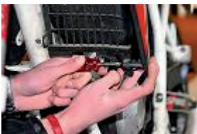
Retirez les vis de fixation inférieures des flans droit et gauche autour du radiateur.
