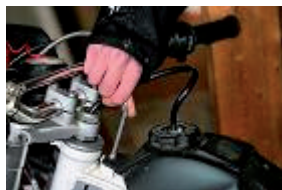
Après avoir retiré les flans, déposez la vis de fixation supérieure du réservoir à l'aide d'une clé allen de 5.
