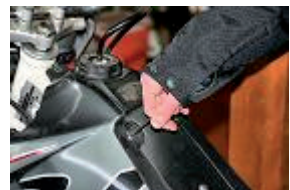
Retirez les vis de fixation supérieures des flans droit et gauche sur le réservoir.
