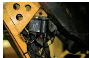
Retirez la bobine haute tension en débranchant tous les câbles.
