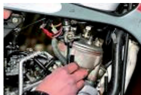
Retirez le tuyau d'essence après avoir fermé le robinet.
