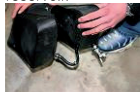
Retirez le réservoir en prenant soin de boucher la mise en parallèle des deux côtés du réservoir.
